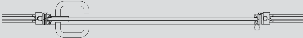
Sezione orizzontale della porta battente vetro con telaio "SLIM". Horizontal section of hinged glass door with SLIM frame
