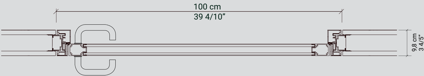
Sezione orizzontale della porta battente doppio vetro con telaio. Horizontal section of hinged double glass door with frame
