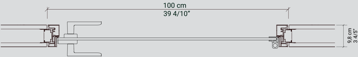
Sezione orizzontale della porta battente in vetro con cerniera continua. Horizontal section of the glass door with continuous hinge.
